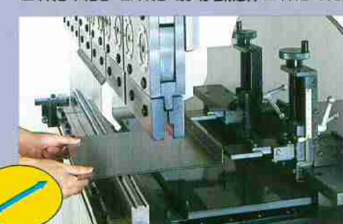
1 Axis NCバックゲージ(100工程) ■TNC-MBM
