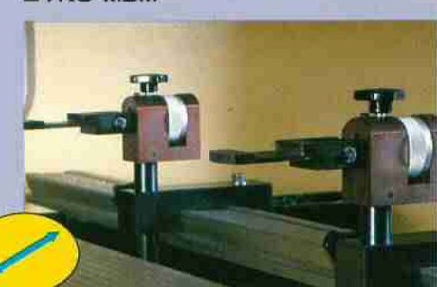
1 Axis NCバックゲージ(10工程) ■TNC 40 AUTO-10P
