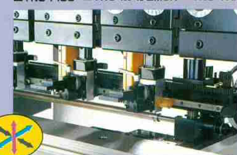
3 Axes NCバックゲージ ■TNC-PICS
