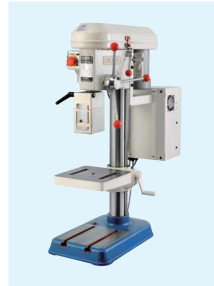
近年の安全に対する強い要望を受け、これまで停止後惰性回転を伴っていた標準機に対し、**即時**停止ボタンを追加したシリーズです。衣服の巻き込まれや工具の食い付きによるワークの回転など、有事の際のけがや事故のリスクを軽減します。背面の制御盤に、インバーターを搭載しており、モーターにブレーキをかけることで、主軸が停止します。
