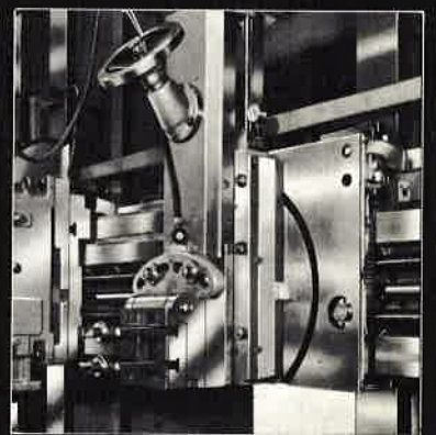
空気と油圧によるツールヘッドバランス装置
