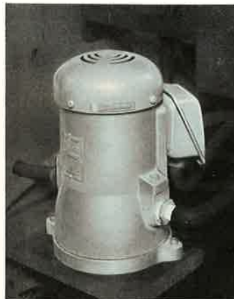
写真-16 冷却剤ポンプ
