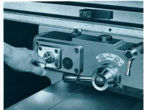
テーブルおよびサドルすべり面 (MH-2・MH-3II)
