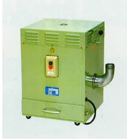
吸塵装置 幅×奥行×高さ(450×450×650) 使用モータ 0.4kW 風量 50Hz 150ℓ/sec、60Hz 180ℓ/sec 静圧 50Hz 170mmA g 、60Hz 250mmA g
