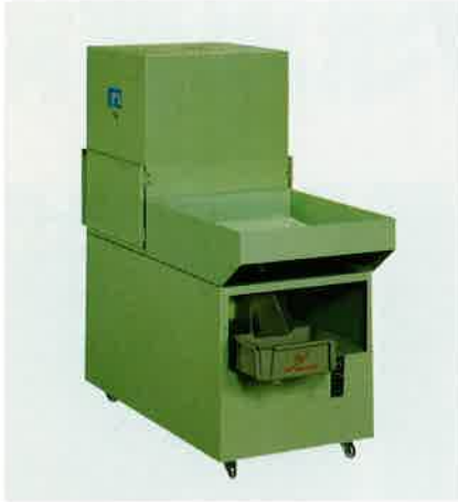
給塵給水装置(マグネットセパレータ付) 幅×奥行×高さ(540×1200×1130) 使用モータ 40W(給水用) 0.4kW(吸塵用) 25W(セパレータ用) 吸塵能力 50/60Hz、9.0/10.8m³/min ポンプ能力 50/60Hz、19/25ℓ/min マグネットセパレータ能力 20ℓ/min タンク容量100ℓ
