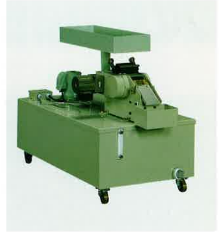
給水装置(マグネットセパレータ付) 幅×奥行×高さ(500×1020×720) 使用モータ 40W(給水用) 25W(セパレータ用) ポンプ能力 50/60Hz、19/25ℓ/min マグネットセパレータ能力 20ℓ/min タンク容量 100ℓ
