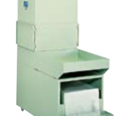
吸塵給水装置 (手動ペーパーフィルタ付) 幅×奥行×高さ (540×1300×1300) 使用モータ 40W(給水用) 0.4kW(吸塵用) ペーパーサイズ 370mm×50mm 吸塵能力 50/60Hz, 9.0/10.8 3 /min ポンプ能力 50/60Hz, 19/25L/min タンク容量 100L Dust collector/Coolant device with manual paper filter winder
