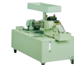
給水装置 (マグネットセパレータ付) 幅×奥行×高さ (500×1020×720) 使用モータ 40W(給水用) 25W(セパレータ用) ポンプ能力 50/60Hz, 19/25L/min マグネットセパレータ能力 20L/min タンク容量 100L Coolant device with magnetic Separator
