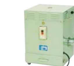
吸塵装置 幅×奥行×高さ (450×450×650) 使用モータ 0.4kW 風量 50Hz 150L/sec, 60Hz 180L/sec 静圧 50Hz 170mmAg, 60Hz 250mmAg Dust collector
