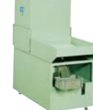
吸塵給水装置 (マグネットセパレータ付) 幅×奥行×高さ (540×1300×1300) 使用モータ 40W(給水用) 0.4kW(吸塵用) 25W(セパレータ用) 吸塵能力 50/60Hz, 9.0/10.8 3 /min ポンプ能力 50/60Hz, 19/25L/min マグネットセパレータ能力 20L/min タンク容量 100L Dust collector/Coolant device with magnetic separator
