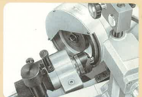
アウトターカッティングアングルの研削
