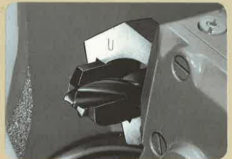
ローソクチップドリルの研削:DG50B
