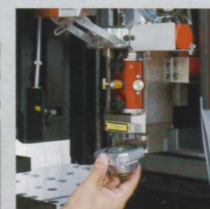
レンズ&ノズル交換作業
