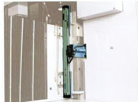
超高精度対応にリニアスケールフィードバック (X、Y、Z軸オプション)
