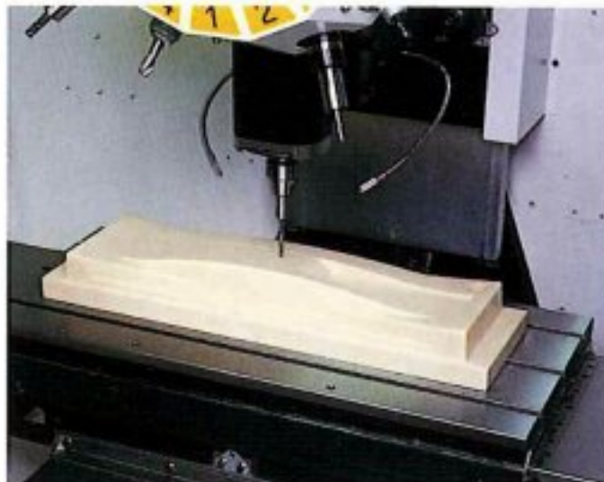
※加工プログラム提供:富士通株式会社殿 (Unigraphicsで作成) ワーク:パソコンフロントパネル 材質:ABS樹脂
