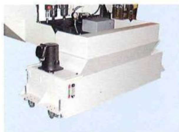
クーラント装置 (タンク部)
