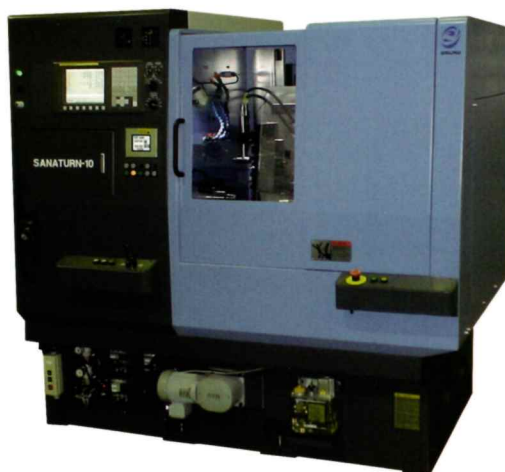
対向2スピンドル3軸制御 CNC 旋盤
