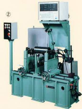
図21 自動角度決め装置つき HCB-100特形
