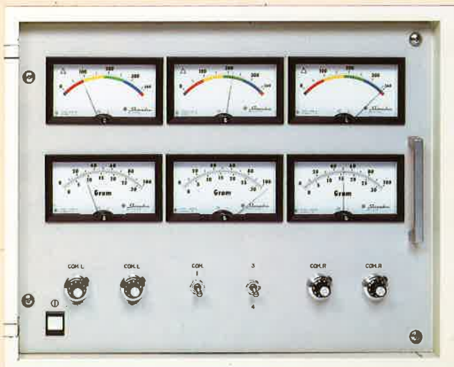
図16 分力多面演算表示装置
