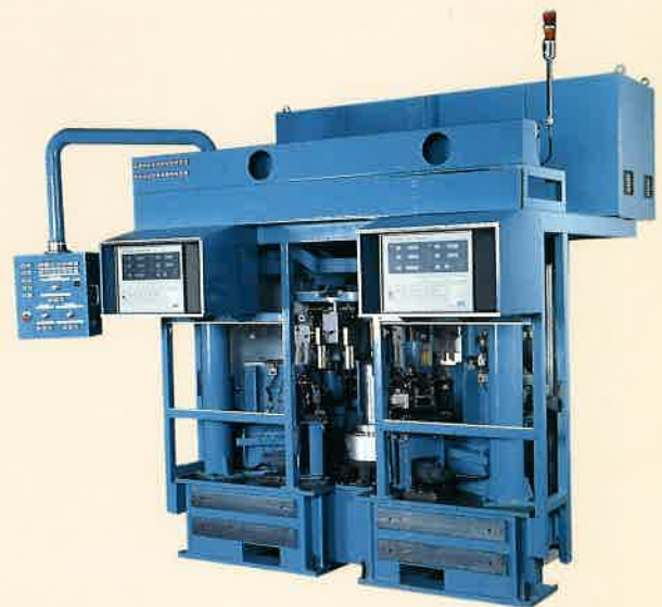
図39 オルタネーター用 全自動釣合修正機DBM-AE形 サイクルタイム:12秒 (ドリルによる除去修正方式)
